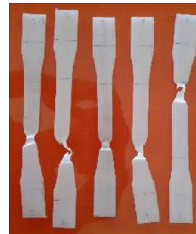
Gambar 10. Proses pengujian spesimen pada mesin uji tarik di Lab. Polimer - LIPI
